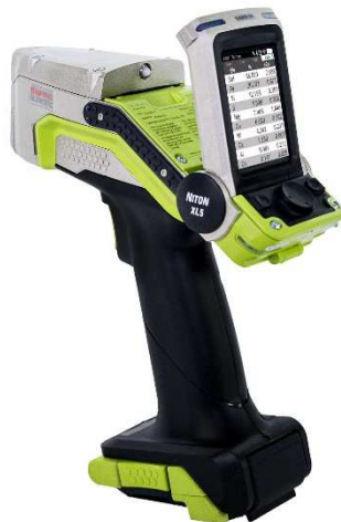
Рис. 5.5.1 Портативный XRF анализатор Niton XL5.
