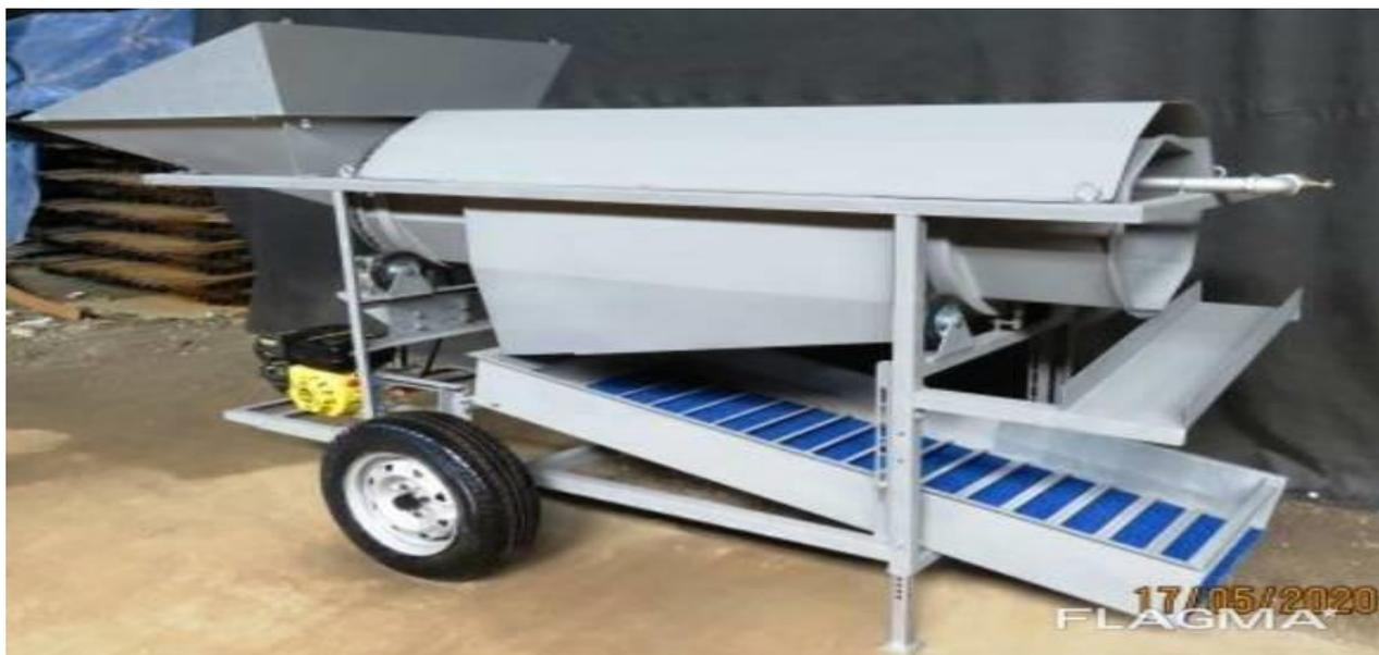
Рис. 1 Компактный мобильный промывочный прибор "ПП - Сибирь 2020"
