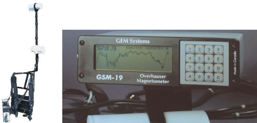
Рис. 5.1. Магнитометр GSM-19W
