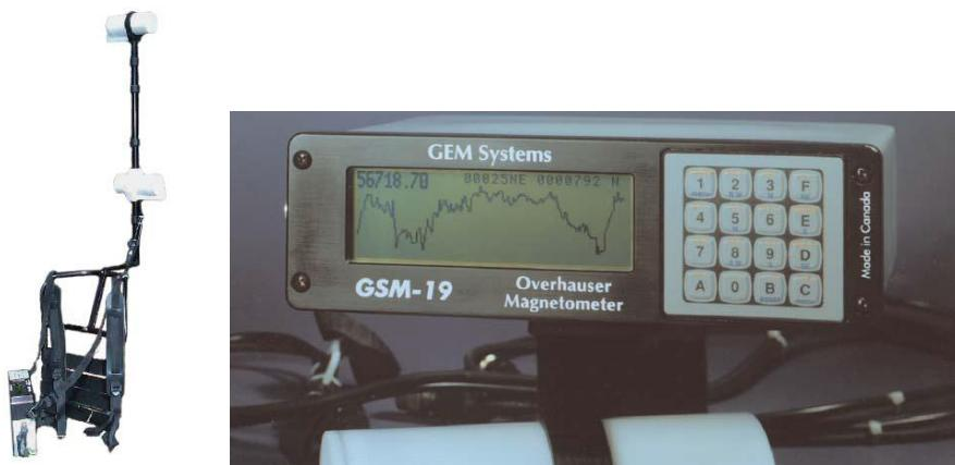
Рис. 5.1. Магнитометр GSM-19W
