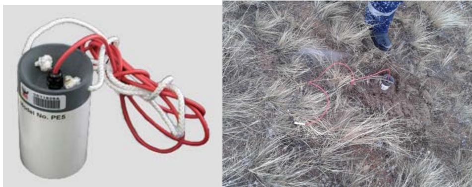
**рис. 1.4.5-7 - Неполаризующийся малощумящий электрод PE5**
