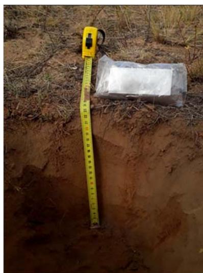
**Рис. 1.4.3-1. Процедура пробоотбора геохимических проб**
