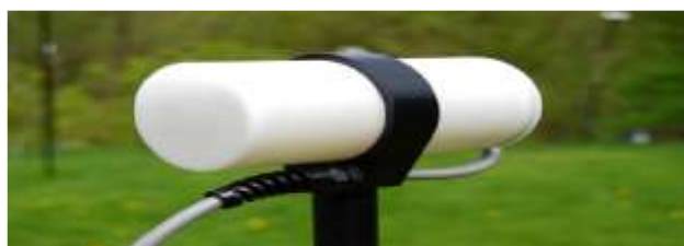
Сенсор GSM-19 с обогащенными свободными радикалами и приемник-регистратор GSM-19
