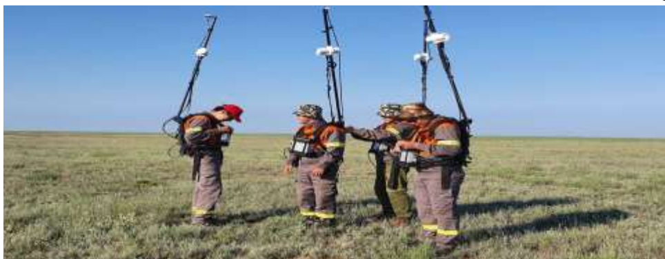
Наземная магниторазведка с модульным магнитометром GSM-19W (Канада)
