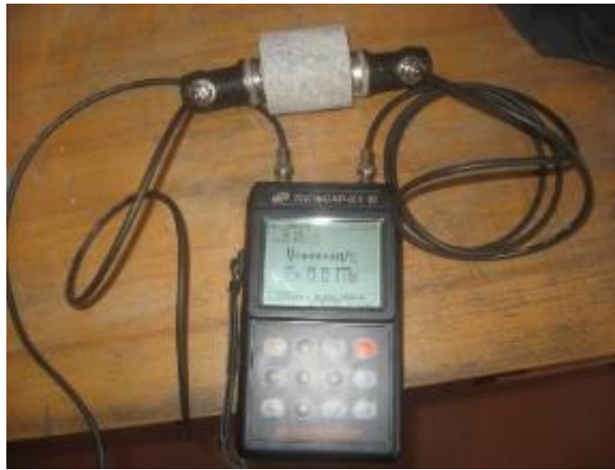
Рисунок 5 – Прибор для определения скорости распространения продольных волн (Пульсар-2.1)
