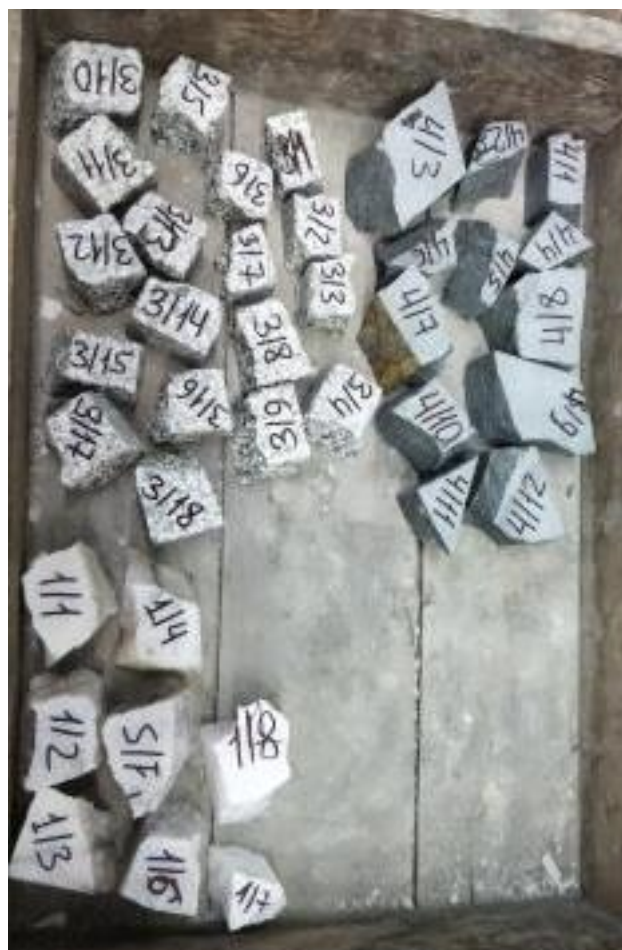
Рисунок 6 – Вид штучных проб в состоянии поставки и образцы, подготовленные к испытаниям
