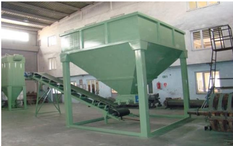
Главный бункер встроенного типа, со шнековым, ленточным питателем
