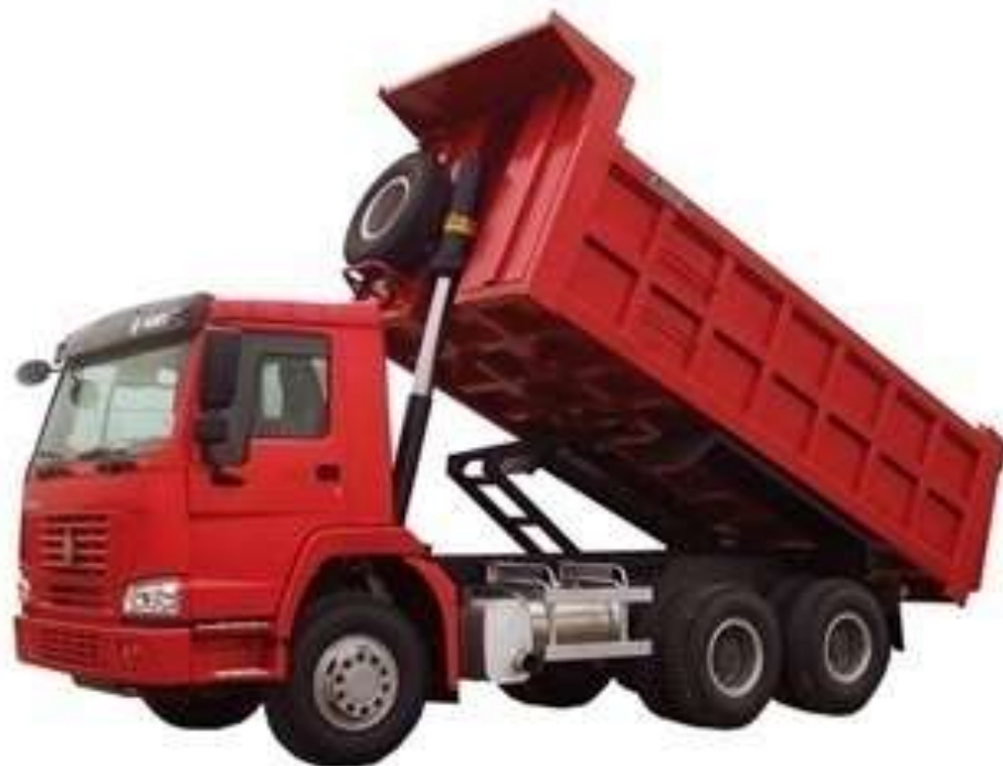
Рис. 3.2.2 - HOWO Самосвал 6x4 (340 л.с.), грузоподъемностью 25 тонн, кузов 5400x2300x1500 мм.
