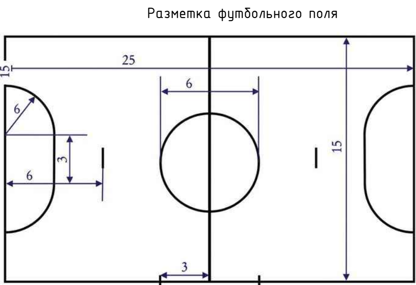
Разметку спортивной площадки по тартановому покрытию выполнять белой акриловой краской. Краску наносить распылителем по трафарету. Ширина полос 50 мм, общая длина 140,0м
