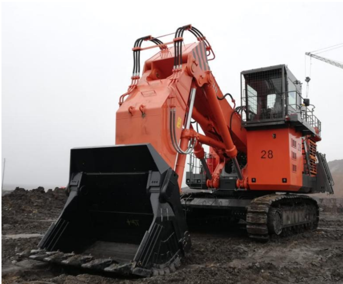
Рисунок 3.10 Гидравлический экскаватор Hitachi EX1900-6 с ковшом 11,0 м 3 .
