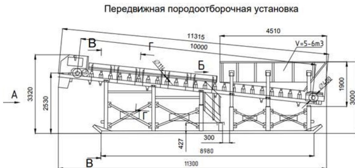
Рис. 4.5. Передвижная породоотборочная установка (ППУ)
