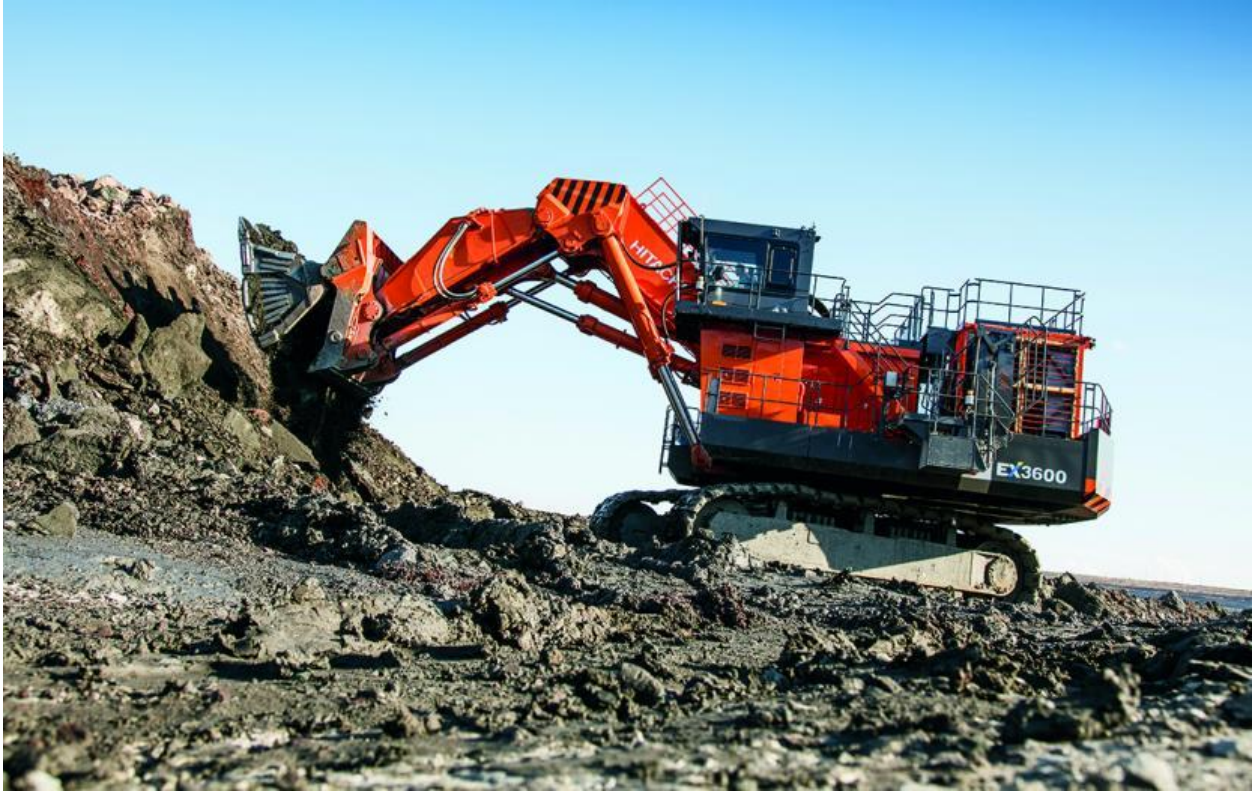
Рисунок 3.13 Гидравлический экскаватор Hitachi EX3600-6 с ковшем 21,0 м³.
