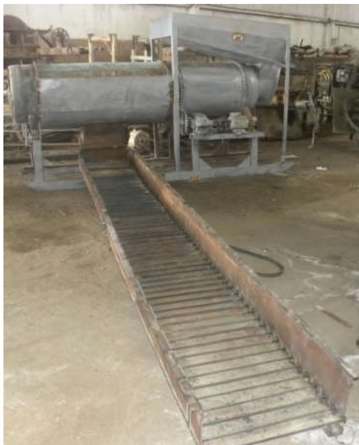
Рис. 5.10.2. Внешний вид промывочной установки со скруббер-батарей
