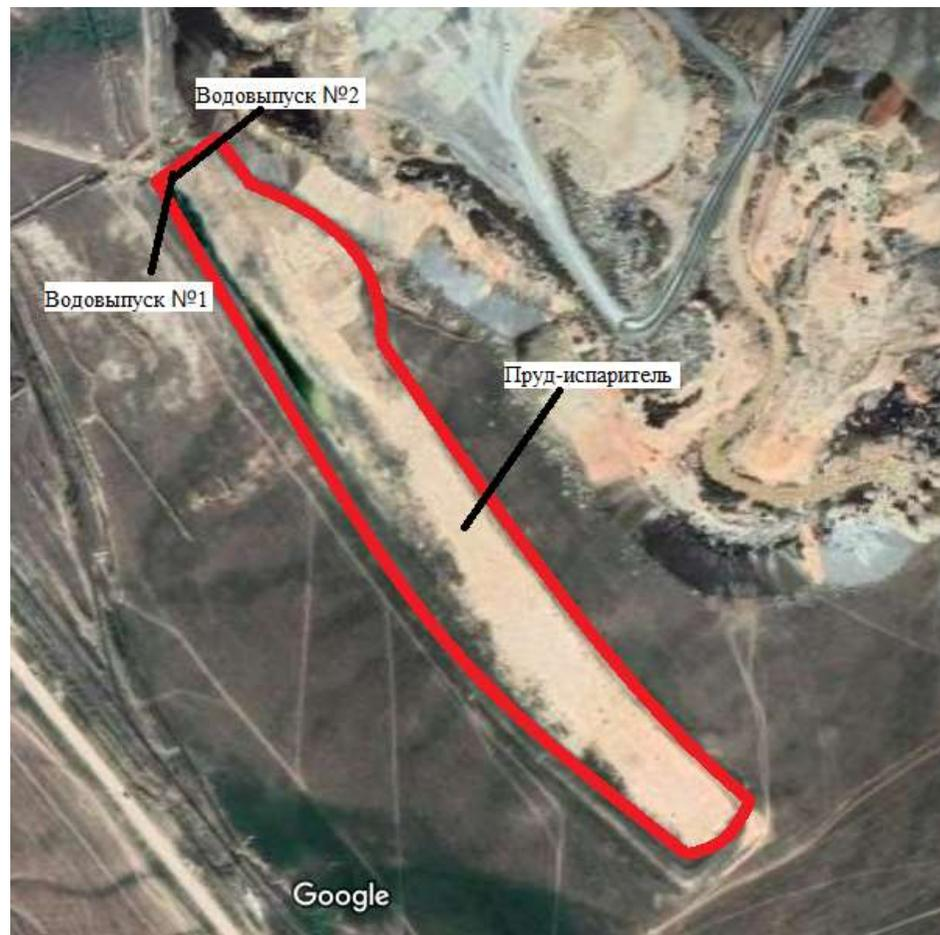
**Рисунок 1.2 –Ситуационная карта-схема района расположения промплощадки рудника «Кентобе» Представительства «Оркен-Кентобе» ТОО «Оркен», с указанием на ней основных объектов рудника, в том числе пруда-испарителя, принимающего сточные воды предприятия, водовыпуск №1, водовыпуск №2**
