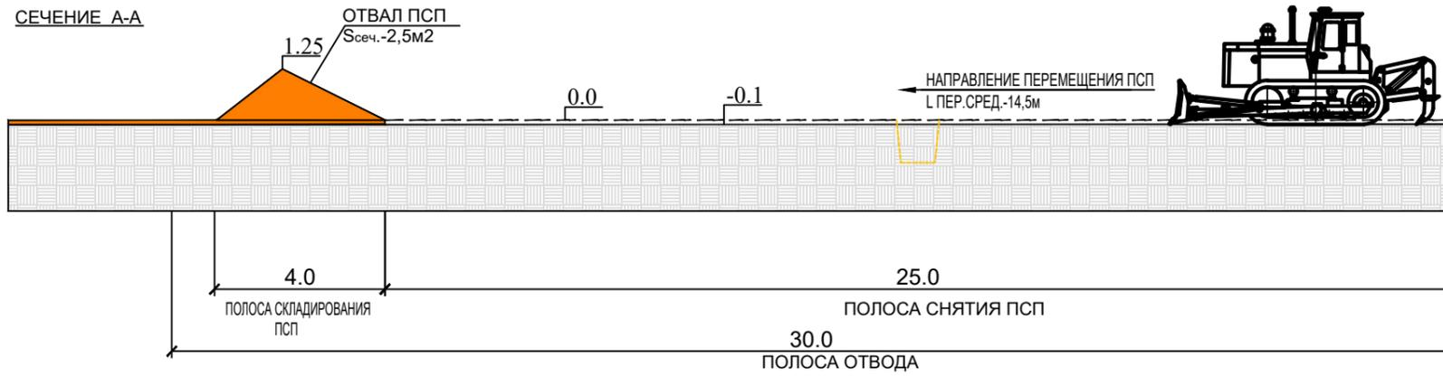
2. СХЕМА СТРОИТЕЛЬНОЙ ПОЛОСЫ ЗАСЫПКИ ТРАНШЕИ БУЛЬДЗЕРОМ
