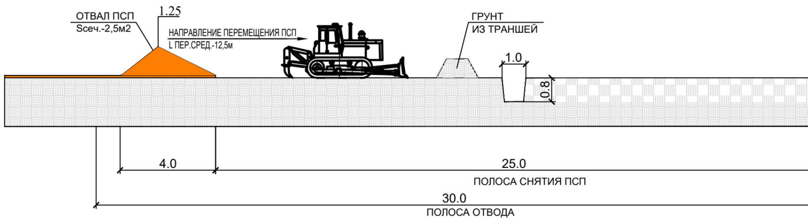
3. НАНЕСЕНИЕ ПСП ПОСЛЕ РАЗВЕДОЧНЫХ РАБОТ
