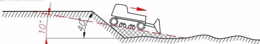
Выполаживание бульдозером бортов карьера до угла не более  $10^\circ$
