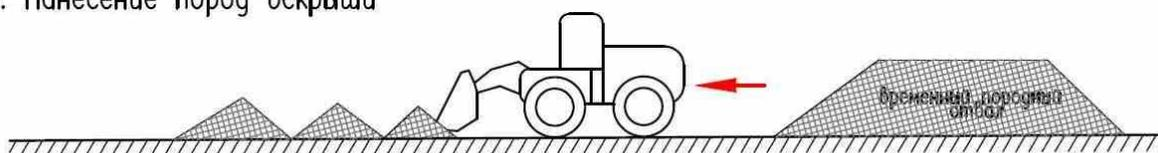
Перемещение пород вскрыши из временного породного отвала на дно и откосы отработанного карьера
