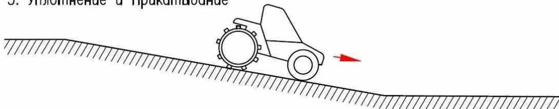
Уплотнение и прикатывание грунта, катком кулачковым на пневмоходу, поверхности дна и откосов карьера
