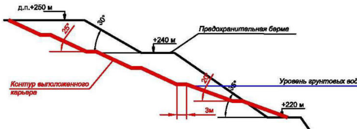
Рисунок 5.5 – Технологическая схема выполаживания бортов карьера
