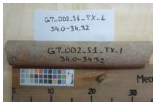
Рис. 23 Пример отбора образца на сжатие, растяжение и трехосное сжатие
