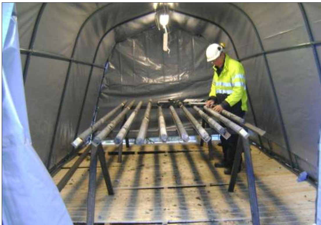
Рис. 6: Рабочее место (стол) для геомеханического документирования керна на месте проведения буровых работ
