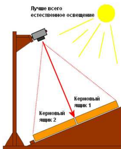
Рис. 15. Принципиальная схема и пример установки для фотографирования керна (участок «Холодная»)
