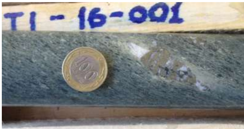
Рис. 18. Примеры детальной фотографий керна: отложение кварцевого материала в тенях давления и трещинах отрыва колчеданного рудокласта в литокластических туфах (кварц-хлорит-серицитовых сланцах), фланги Тишинского м-ния. Основной недостаток фото – отсутствие стандартной масштабной шкалы и подписи глубины.
