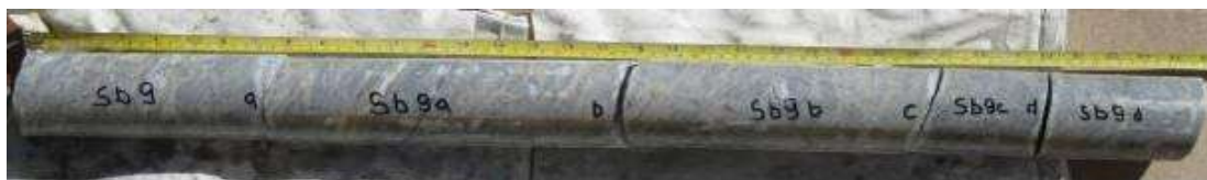
Рис. 24. Пример отбора образцов, содержащего трещины с зеркалами скольжения
