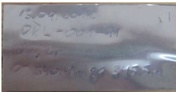
Рис. 9. Образец алюминиевой бирки с дублирующей информацией
