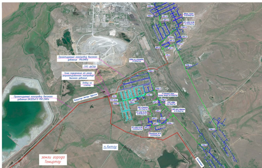
Рисунок 2.2.2 – Схема трассы распределительных газопроводов высокого давления РН 0,6 МПа и внутрипоселковых сетей газоснабжения п.Актау
