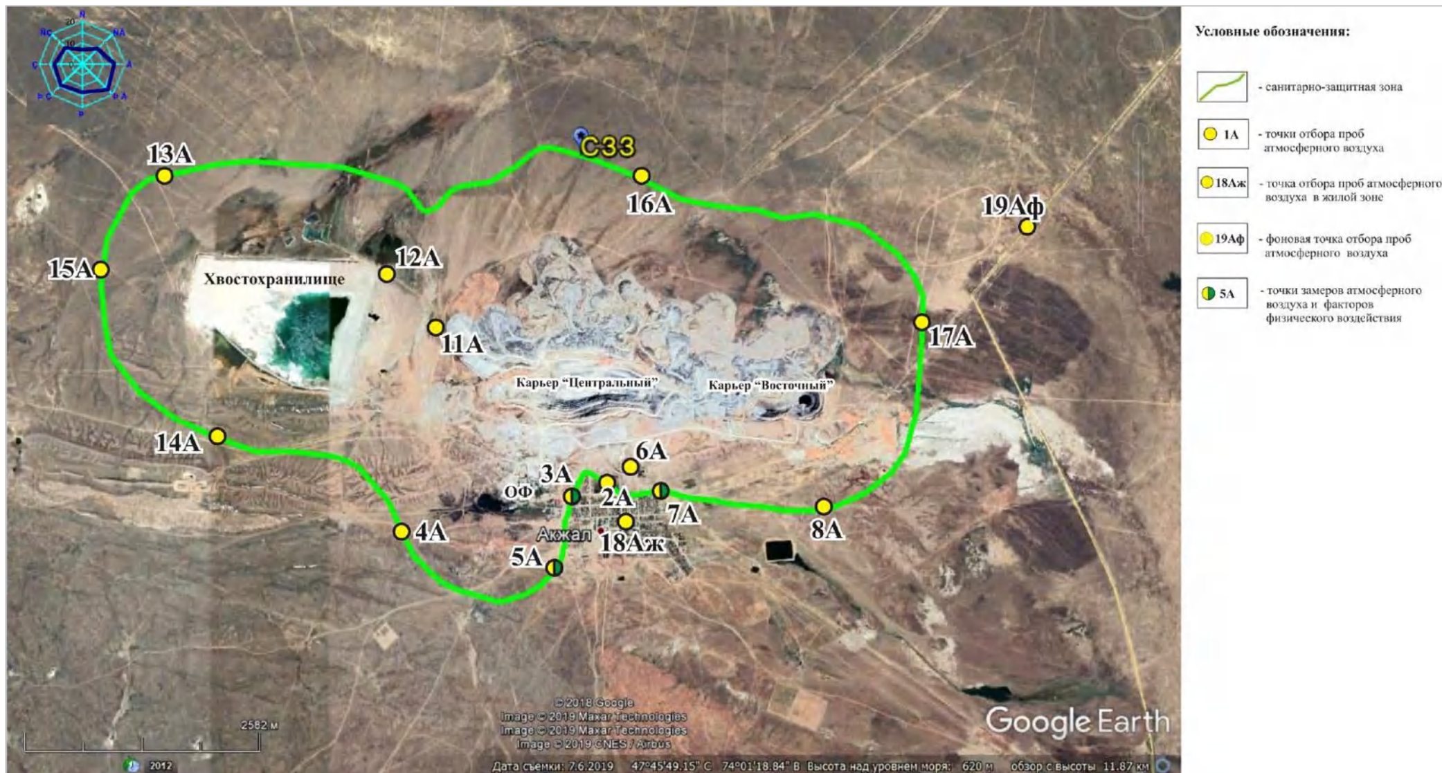
Рисунок П2.2 – Карта-схема промплощадки № 1 ТОО «Nova Цинк» с указанием точек мониторинга атмосферного воздуха
