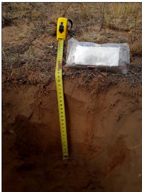
Рис.5.1 - Процедура пробоотбора геохимических проб
