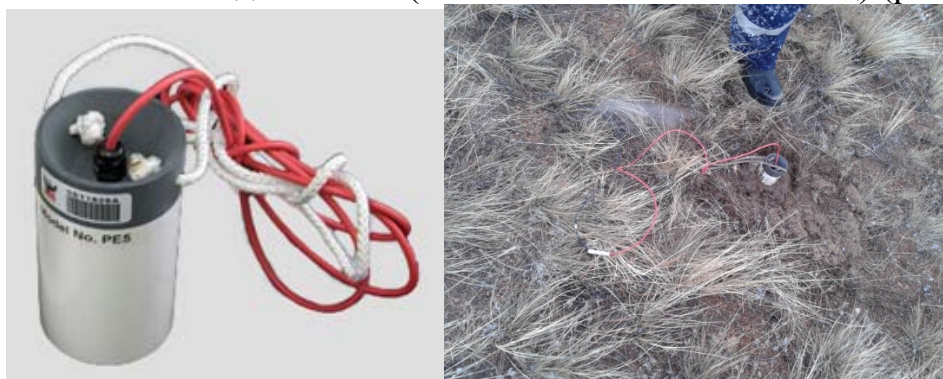
Рис. 5.9 - Неполяризующийся малошумящий электрод PE5
