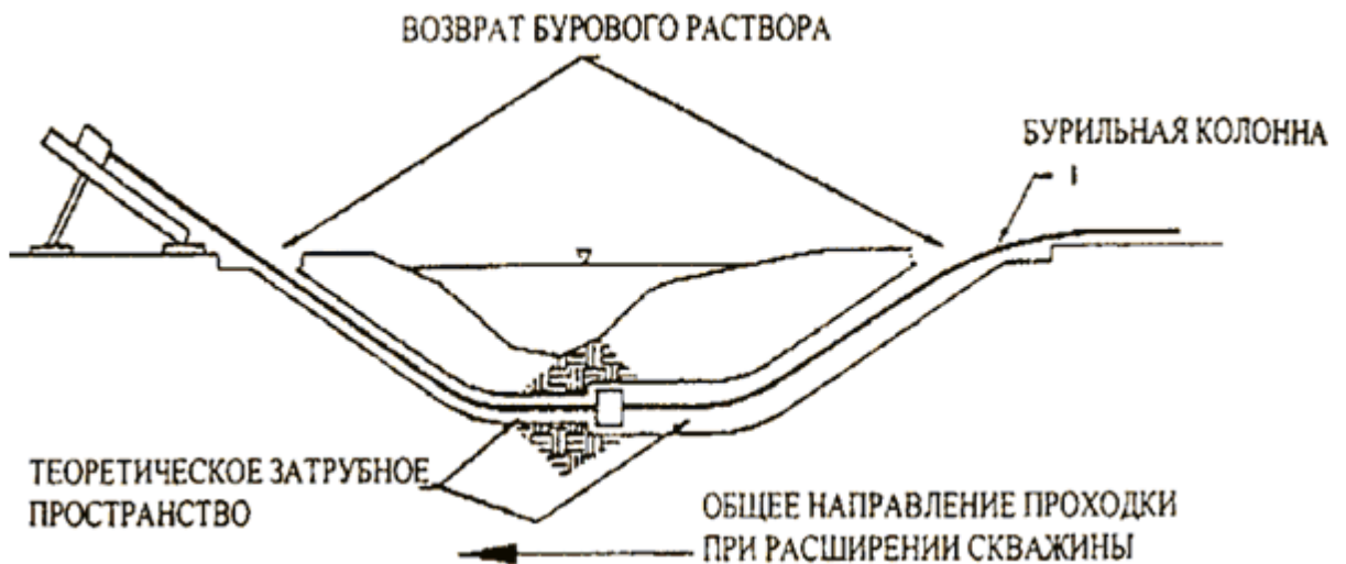
Рисунок 2. Расширение пионерной скважины
