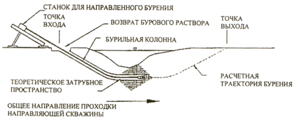
Рисунок 4.1. Бурение пионерной скважины
