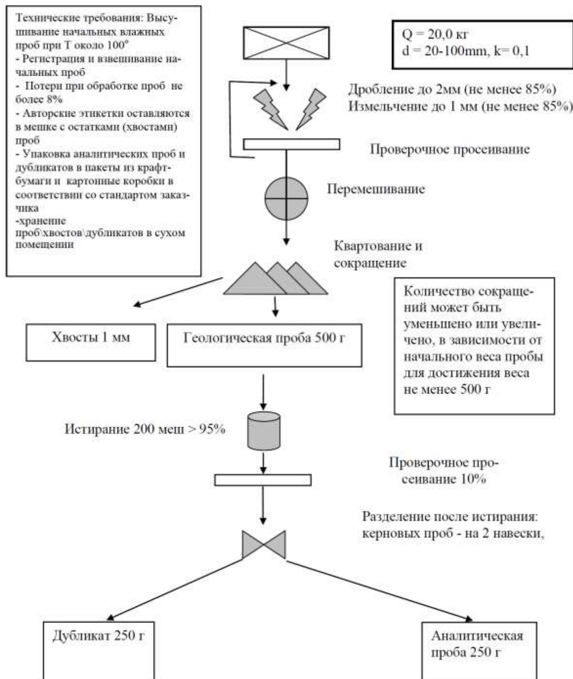
Рис. 5.4 - Схема обработки бороздовых проб
