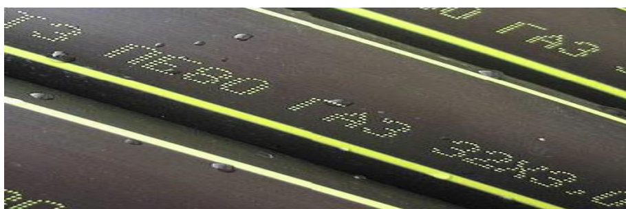
Рисунок 2.5.2.1 - Маркировка полиэтиленовых труб
