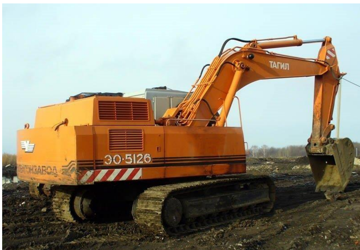
Рисунок 6.5 Гидравлический экскаватор ЭО-5126 с ковшом 1,5 м 3 .
