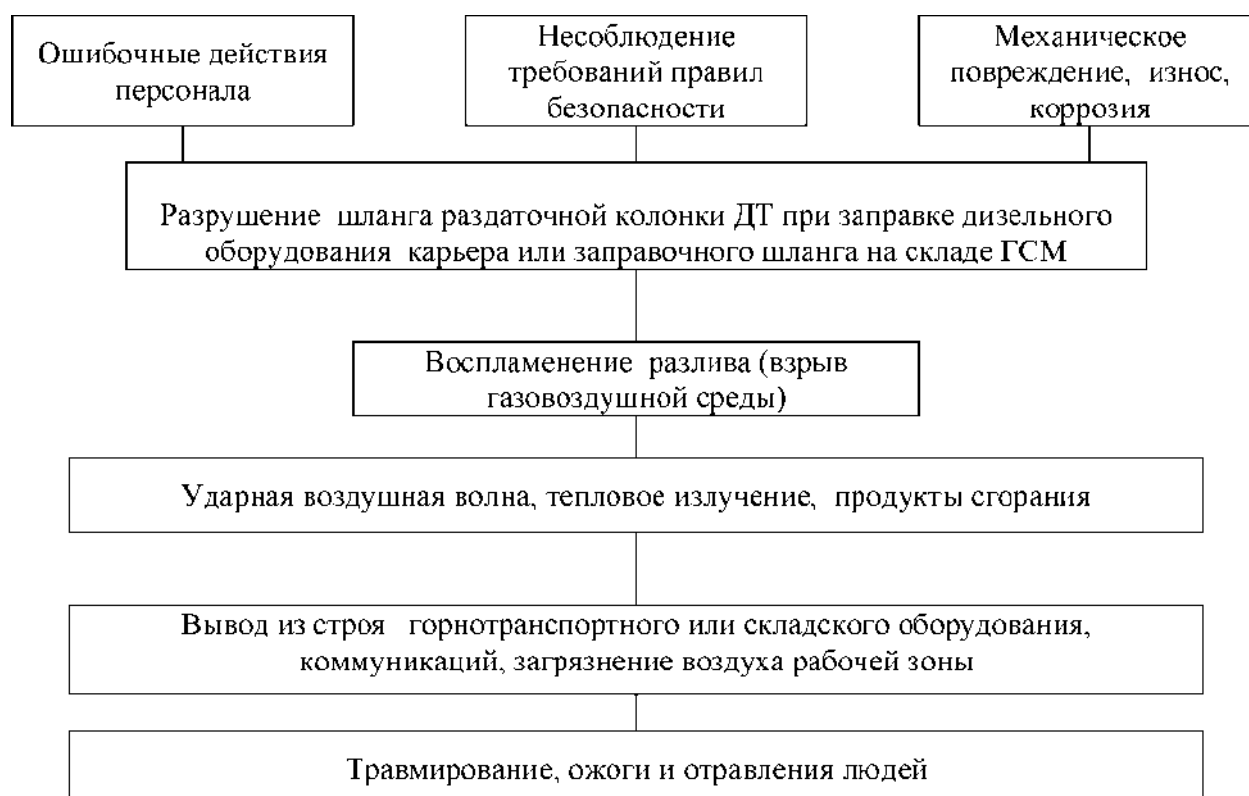
Рис. 13.3. Блок-схема вероятного сценария возникновения и развития аварии при заправке дизельного технологического оборудования карьера из топливозаправщика или заправке дизельного технологического оборудования карьера из топливозаправщика.
