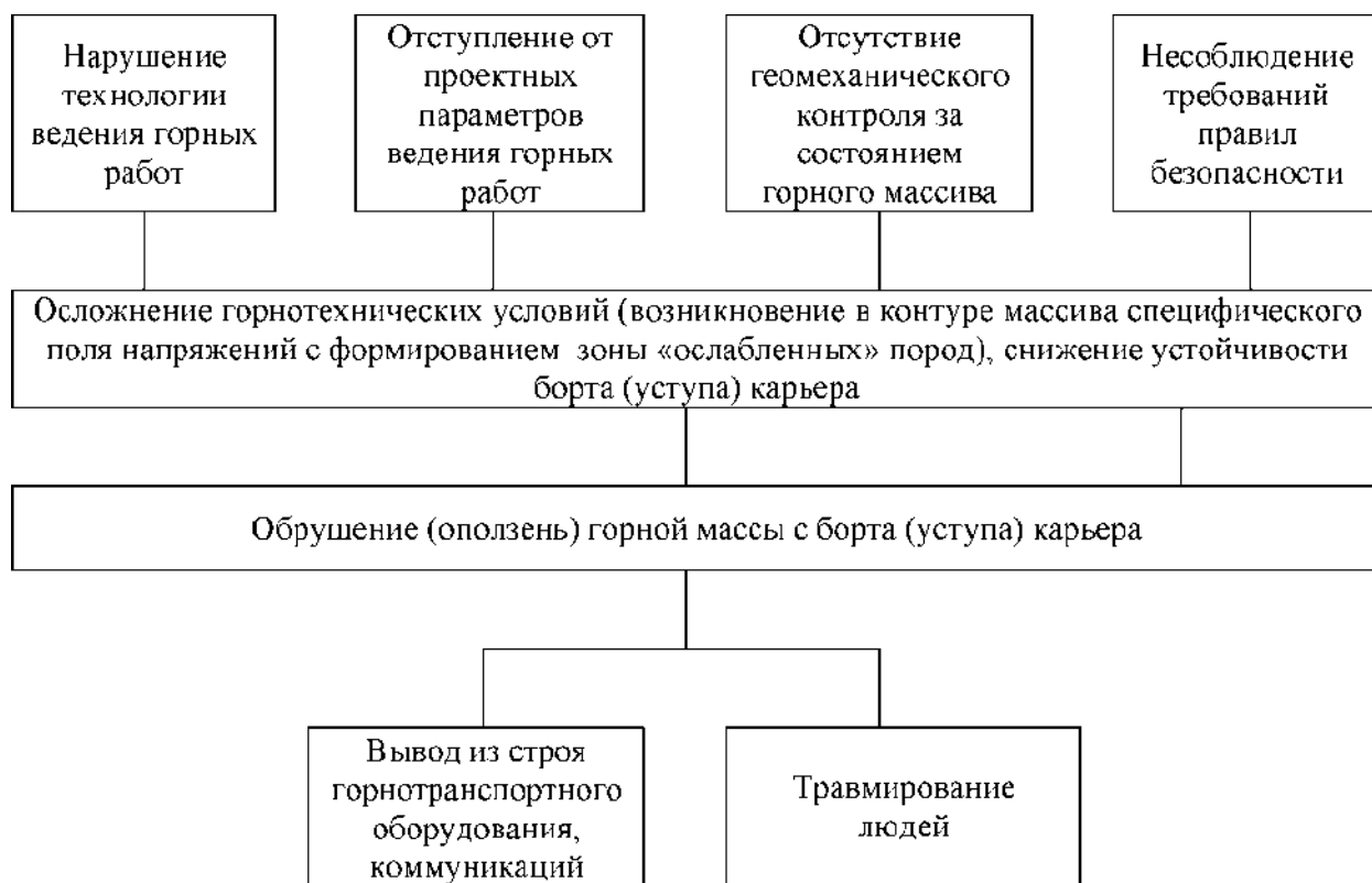
Рис. 13.1. Блок-схема вероятного сценария аварии при обрушении (оползней) горной массы с борта (уступа) карьера
