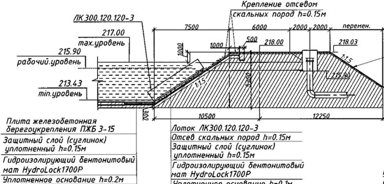
Схема раскладки ЖБ элементов
