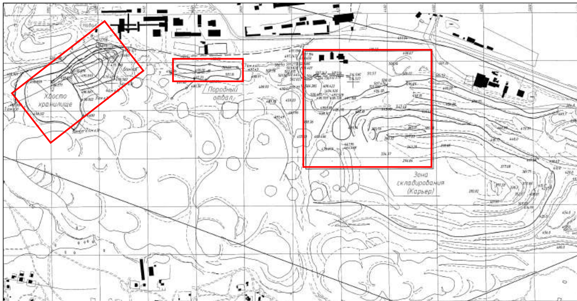
Рис. 1.2 - Схема расположения отвала, хвостохранилища и выработанного пространства карьера.
