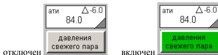
Рисунок 115 – Элементы интерфейса защитного регулятора
