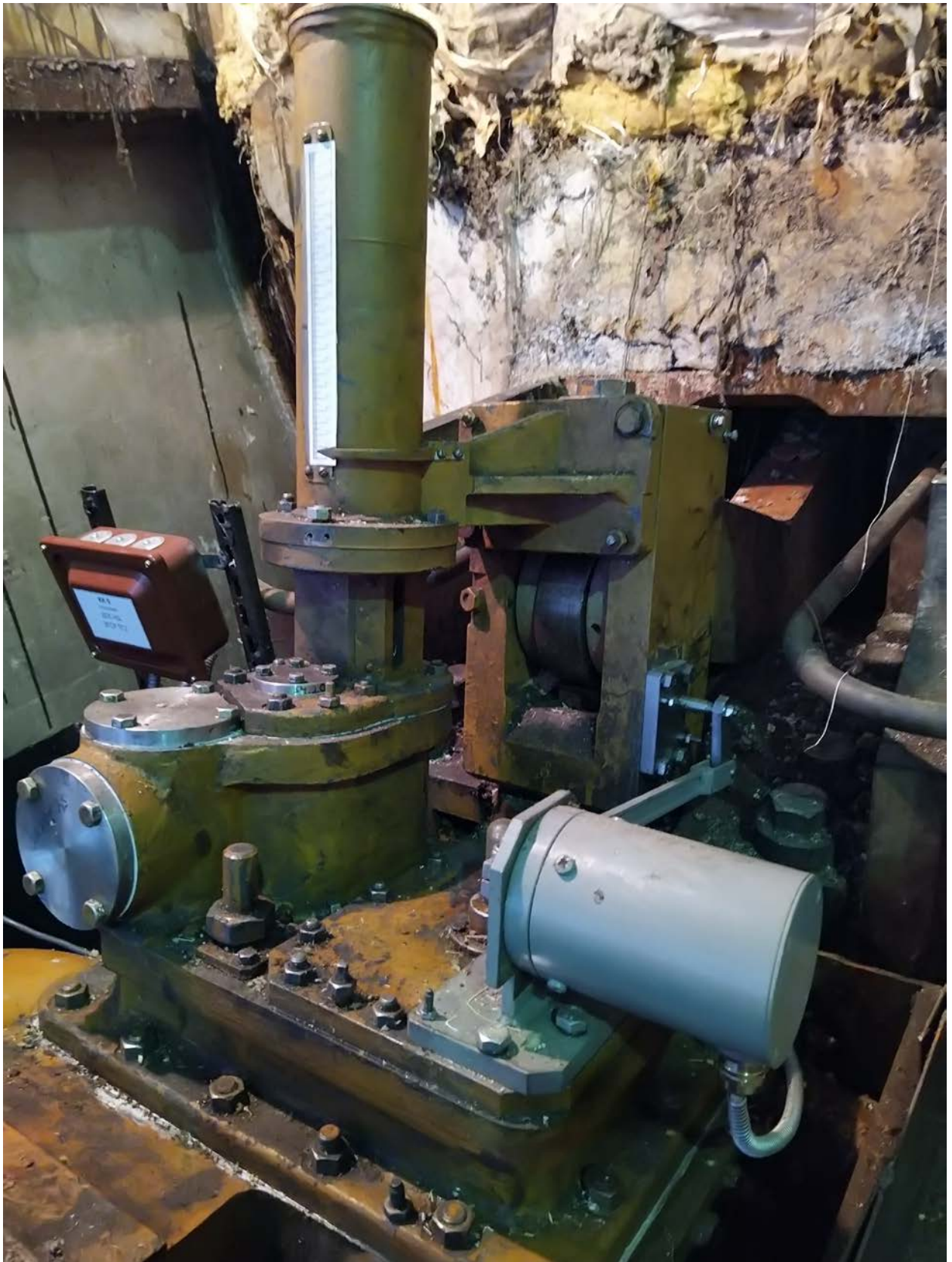
Рисунок 18. Пример установки датчика положения сервомотора.
