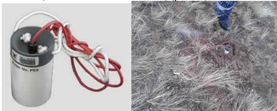
Рис. 5.9 - Неполяризующийся малошумящий электрод PE5
