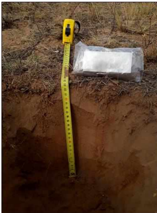
Рис.5.1 - Процедура пробоотбора геохимических проб
