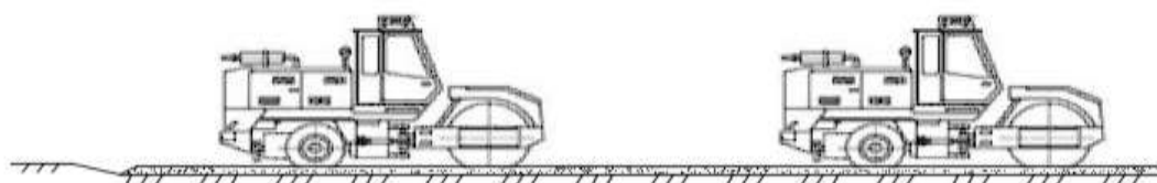
Укатка выровненного слоя Виброкаток CAT CS76XT (CS78B)
