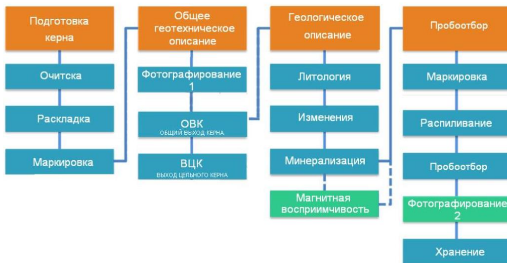
Рис. 4.3. Технологическая схема документации и обработки керна
