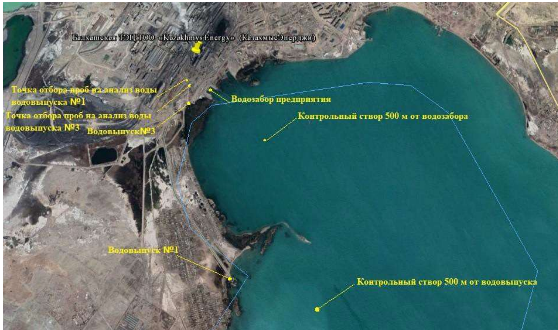
Рисунок 3. 1. Схема с выпусками и точками контроля качества вод
