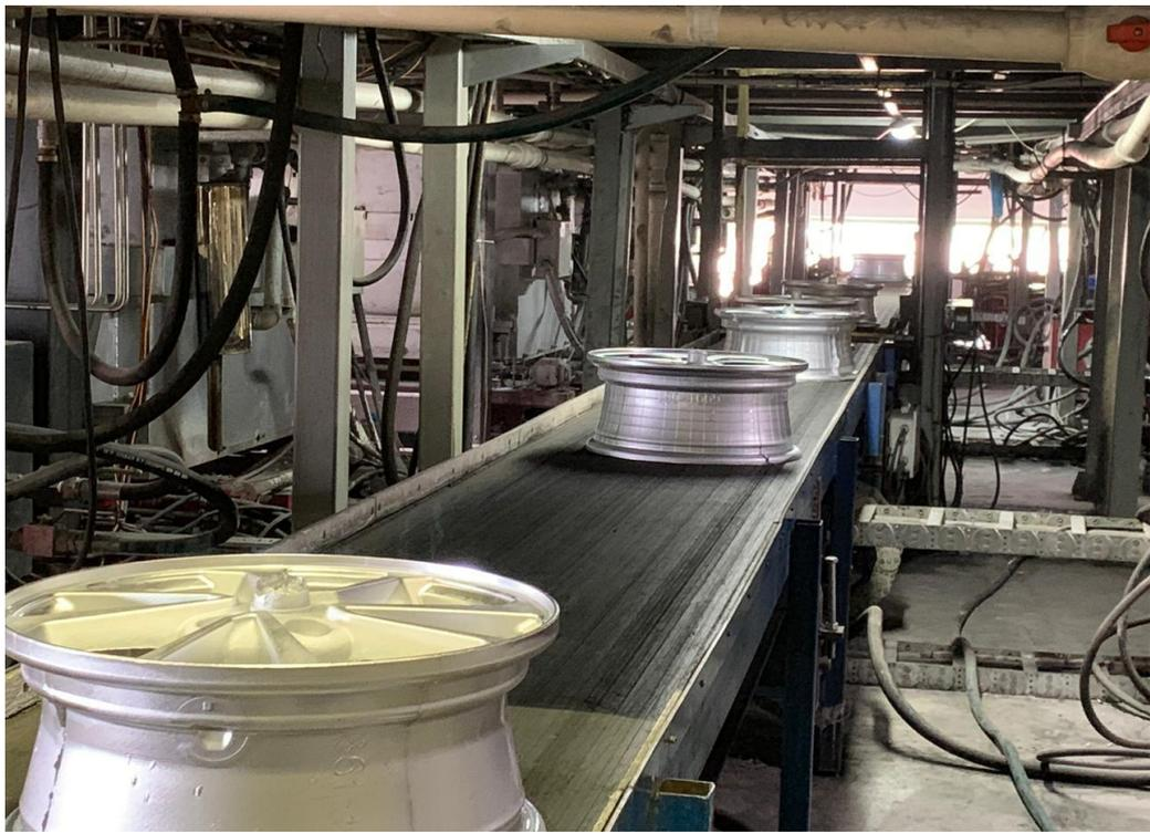
Уровень автоматизации литейного оборудования на производстве позволяет четко отслеживать и поддерживать в нужных рамках параметры процессов литья, обеспечивая их стабильность и направленную кристаллизацию сплава.
