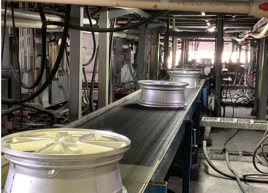
Уровень автоматизации литейного оборудования на производстве позволяет четко отслеживать и поддерживать в нужных рамках параметры процессов литья, обеспечивая их стабильность и направленную кристаллизацию сплава.
