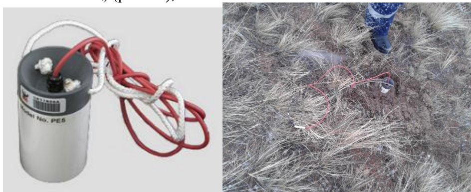
Рис. 5.9 - Непольаризующийся малошумящий электрод PE5
