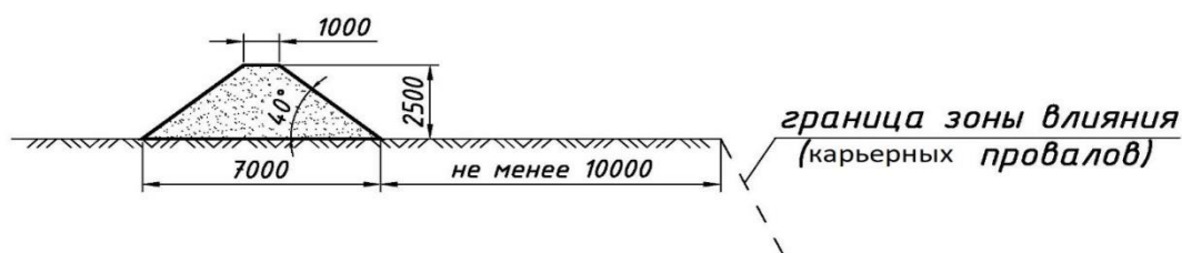
Рисунок 5.2. Поперечный разрез породного вала
