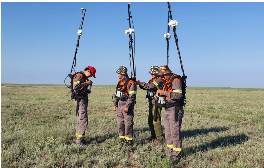
Рисунок 8.3 – Выполнение наземной электроразведки с помощью модульного магнитометра GSM-19W (Канада)
