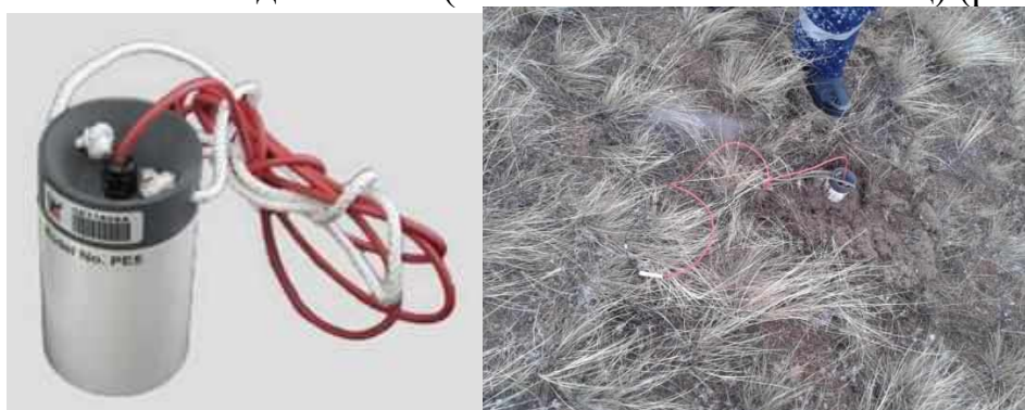
Рис. 5.9 - Неполяризующийся малозумящий электрод PE5
