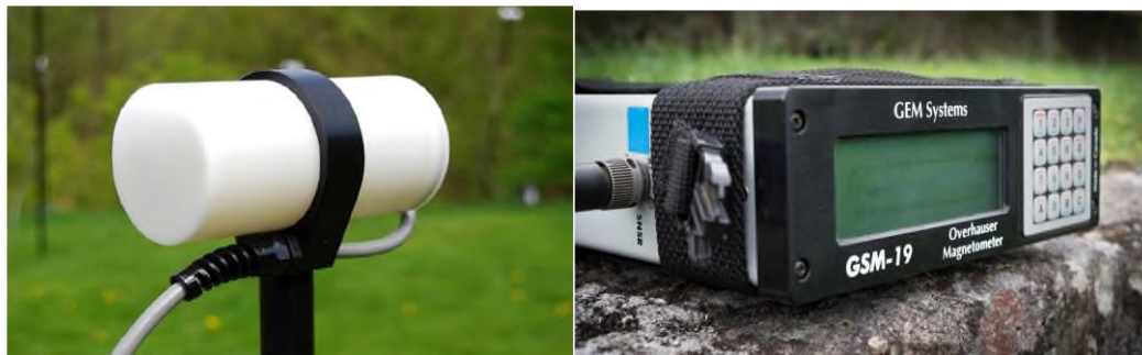
Рисунок 8.1 – Сенсор GSM-19 с обогащёнными свободными радикалами и приемник-регистратор GSM-19
