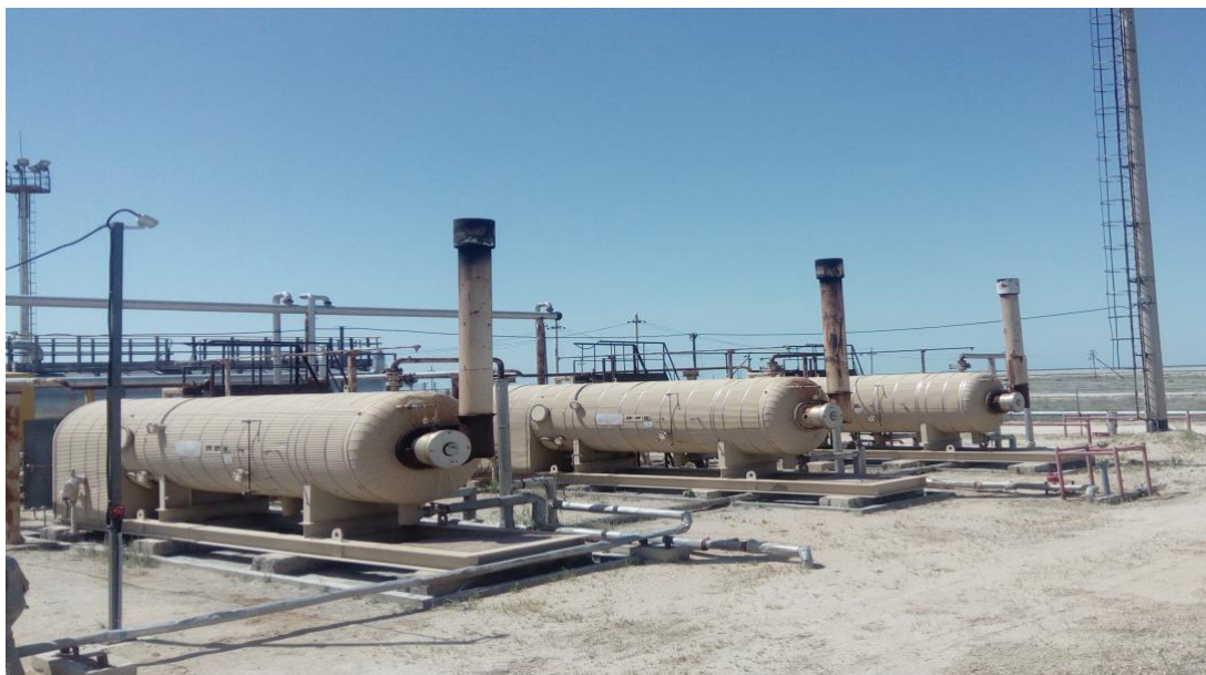
Рис. 1.1.4 Трехфазный тестовый сепаратор
