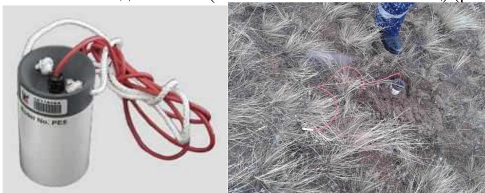
Рис. 5.9 - Неполяризующийся малошумящий электрод PE5
