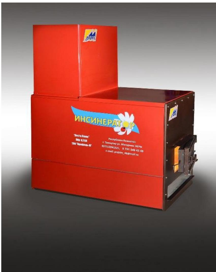
Печь выполнена в форме L-образной конструкции и состоит из двух топок — горизонтальной и вертикальной (дожигательной камеры). В горизонтальной топке происходит непосредственно сам процесс сжигания отходов, где температура достигает 1000 градусов Цельсия. В вертикальной топке (дожигательной камере) за
