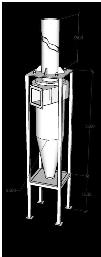
СГС - 01 изготавливаются левого и правого исполнения. Они могут устанавливаться как на всасывающей линии вентилятора, так и на нагнетании. В зависимости от этого одиночный циклон комплектуется с улиткой на выходе очищенного воздуха или зонтом. При очистке воздуха от абразивной пыли, вызывающей износ крыльчаток вентилятора, циклоны рекомендуется устанавливать перед вентилятором.
