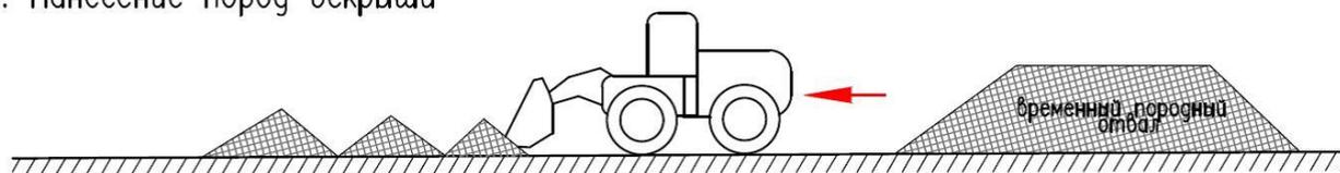
Перемещение пород вскрыши из временного породного отвала на дно и откосы отработанного карьера
