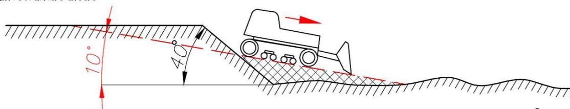
Выполаживание бульдозером бортов карьера до угла не более  $10^\circ$
