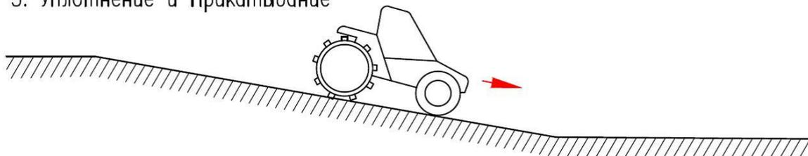
Уплотнение и прикатывание грунта, катком дорожным вибрационным, поверхности откосов и дна карьера
