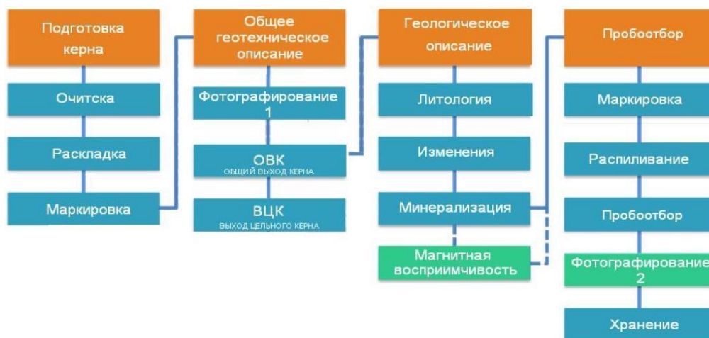
Рис. 4. Технологическая схема документации и обработки керна
