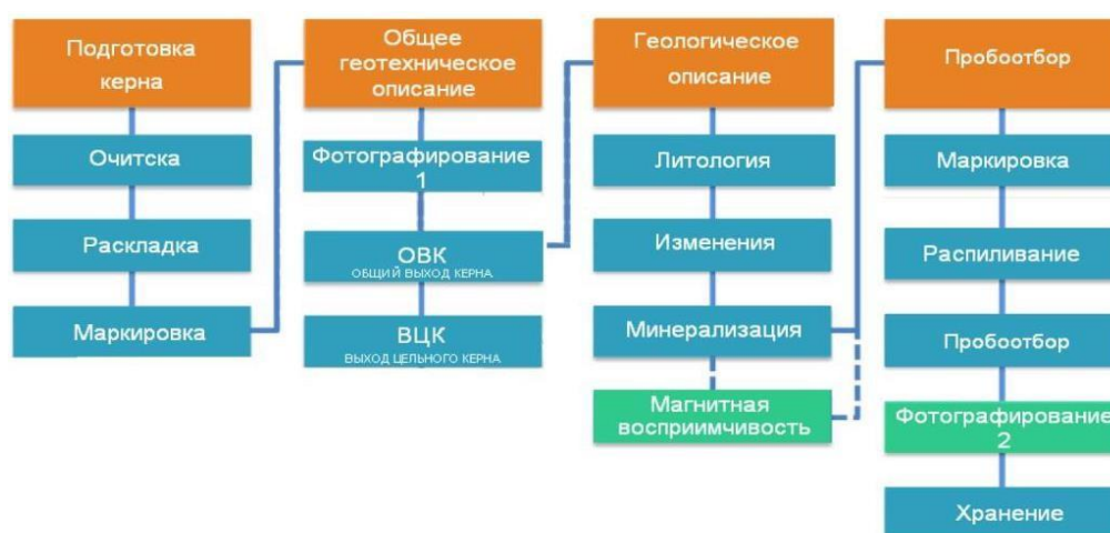
Рис. 4. Технологическая схема документации и обработки керна
