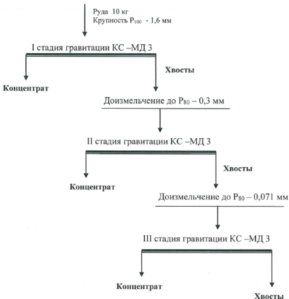
Рисунок 8.1 – Схема проведения GRG-теста
