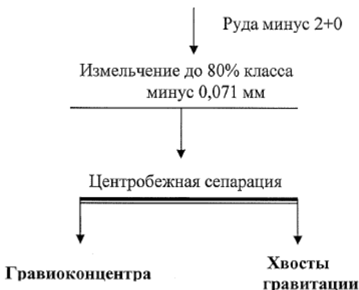
Рис. 8.5 – Схема опытов по выделению гравитационного концентрата
