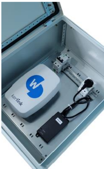
Рисунок 6.2.1 Внешний вид шкафа системы мониторинга (пример)
