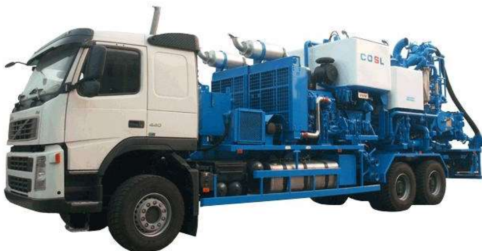
Рис. 3.1.1 Цементируочный агрегат ЦА-320
