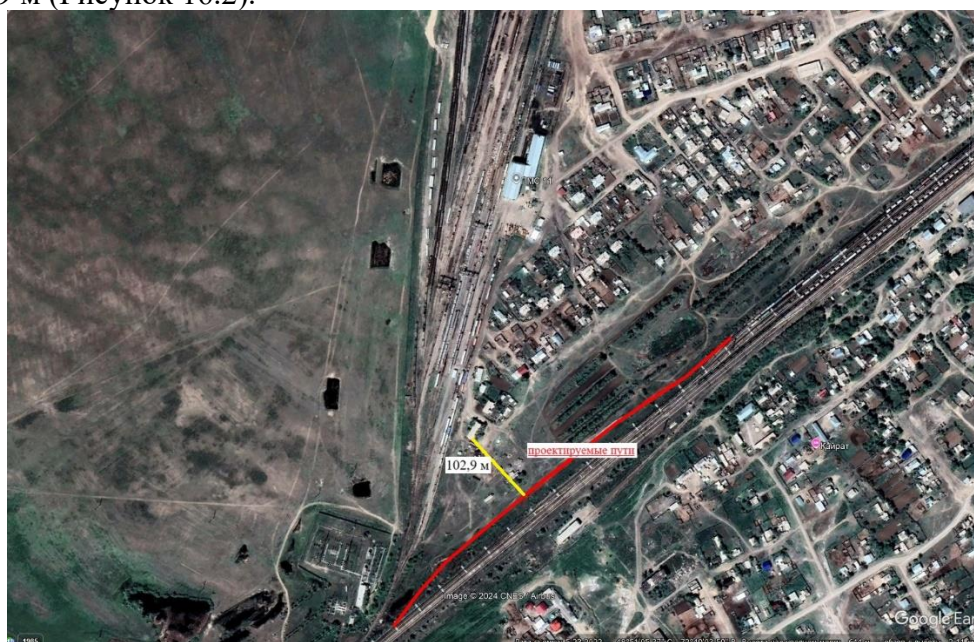
Рисунок 16.2. Расстояние от проектируемого пути до жилой зоны
