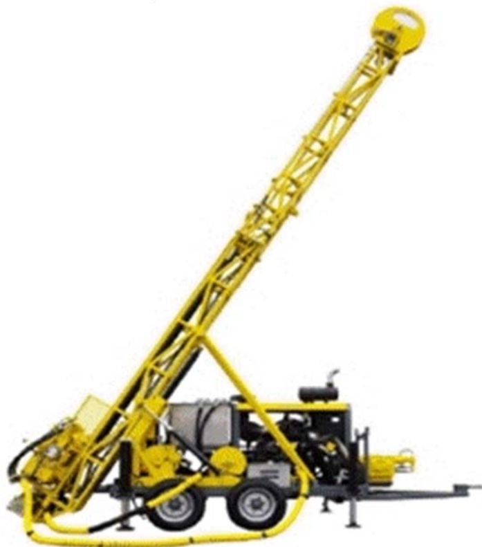
Рисунок 3-1 Буровая установка марки Epiroc Boyles C6
